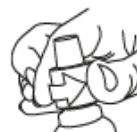
Ouvrir le bouchon en tournant dans le sens contraire des aiguilles d'une montre.
